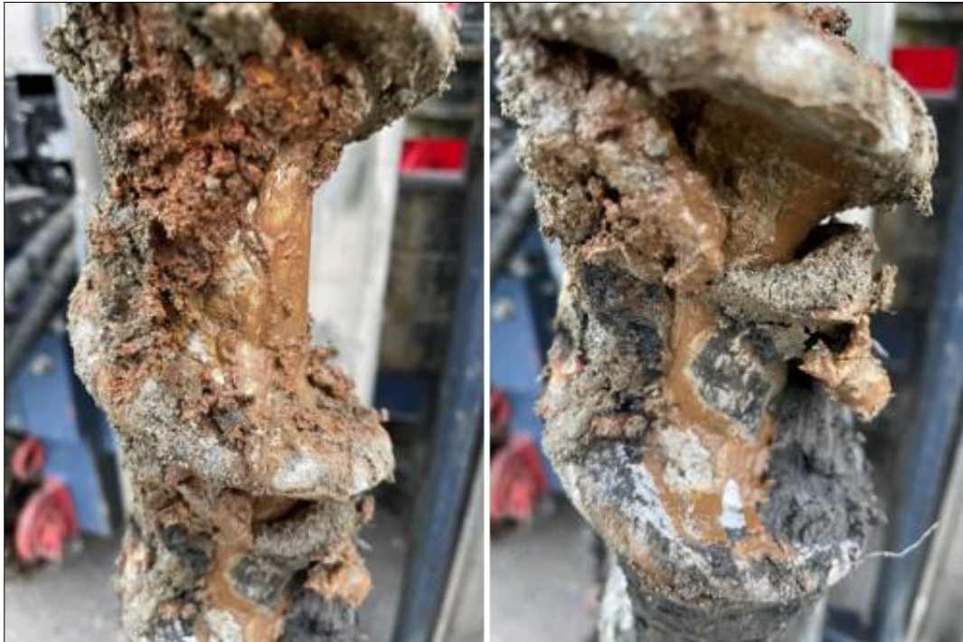
Figur 2. Fyllnadsmassor bestående av sandigt grus, grus och mindre sten med övergång till lerigt fyllnadsmaterial med inslag av tegelrester.
