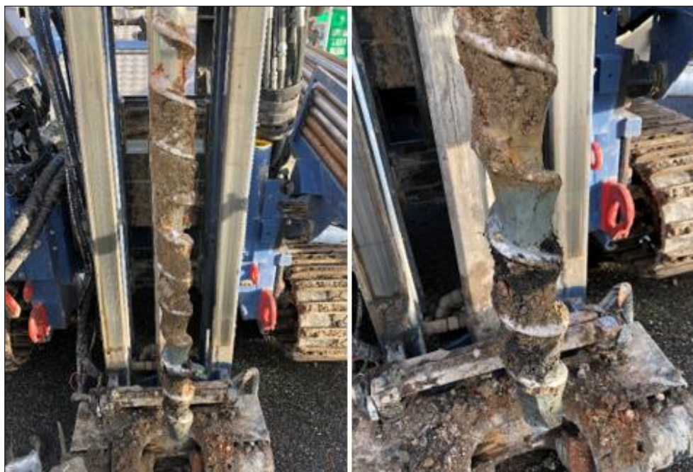
Figur 2. Jordlagerföljder med fyllnadsmassor av grusig sand respektive lera i borrhpunkt 23LC50.
