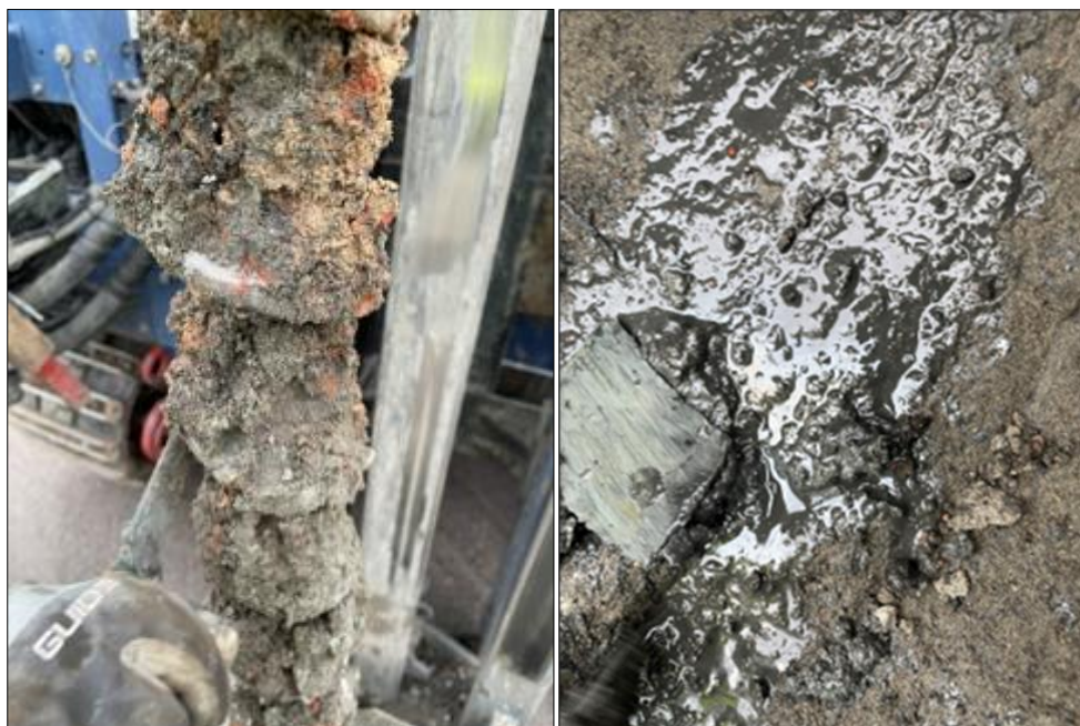
Figur 2. Visar fyllnadsmassor på skruv 23LC01 - lera, tegelrester och orange sand samt oljefilm på vatten som följde med upp på skruven i 23LC06
